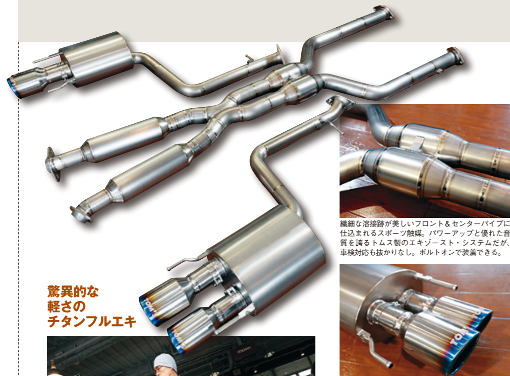
チタニウムでできているマフラー・カッターはTOM'Sのロゴと美しい焼き色が目立つ。左右4本出しのカッターは独立したパーツになっていて、車体からの突き出し量を任意に調整できるようになっている。
