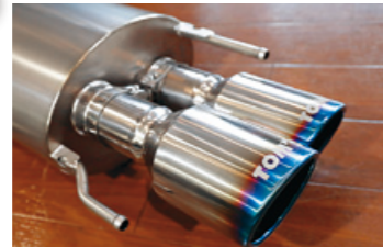
チタニウムでできているマフラー・カッターはTOM'Sのロゴと美しい焼き色が目立つ。左右4本出しのカッターは独立したパーツになっていて、車体からの突き出し量を任意に調整できるようになっている。
