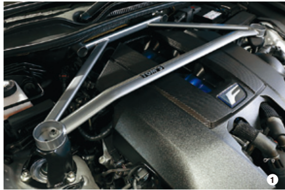
①アッパーパフォーマンスロッドは三角形に結ばれ剛性を確保。②トランク内にアッパーパフォーマンスロッドが通る。③フロントサブフレーム基部を固めるサスペンションメンバー強化ブレース。④2本のサスペンションメンバー強化ブレースはリヤサブフレームとボディを締結。
