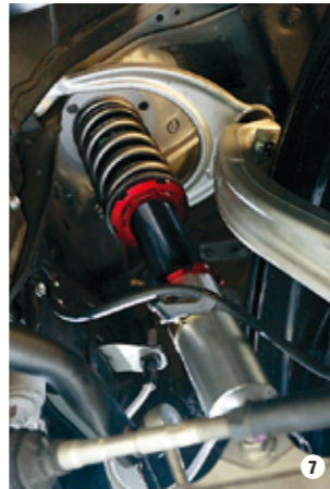
⑦車高調整、減衰力調整が可能なトムス・レーシング・サスペンションキット。⑧ホイールは今回からENKEIのRacing GTC01を装着。マルチスポークの形状をはじめとして、スーパーGTからのフィードバックが数多く含まれている。
