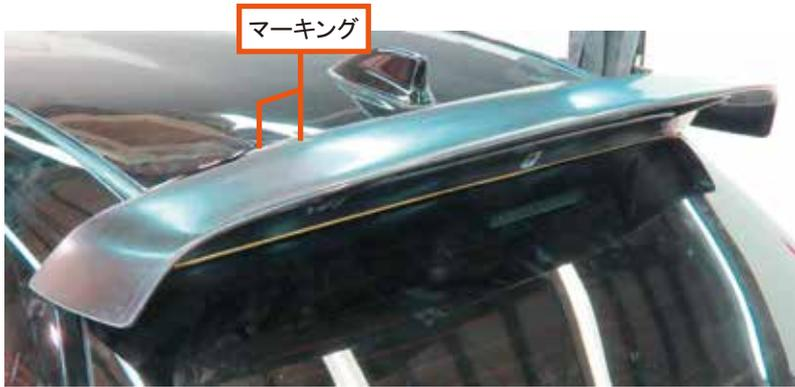
6. ①ウイングを車両に仮付けし、脚部上面 2 箇所の取り付け穴をマジック等でマーキングする。
