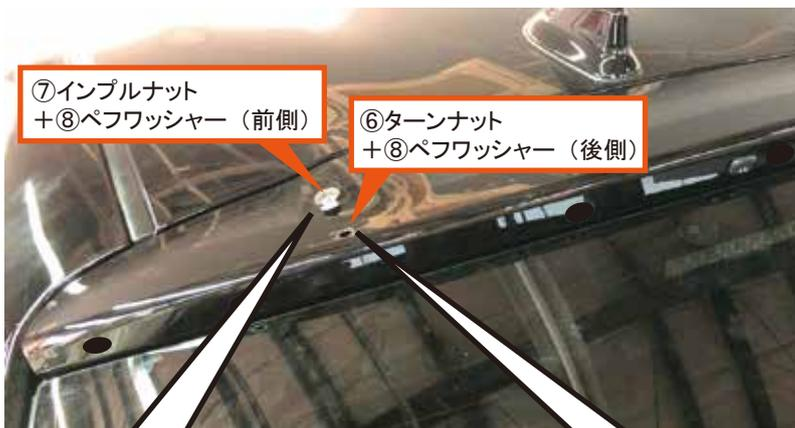
9. 10φ穴、10.5φ穴に⑧ペフワッシャーを貼り付け、10φに⑥ターンナット、10.5φ穴に⑦インプルナットを取り付ける。
