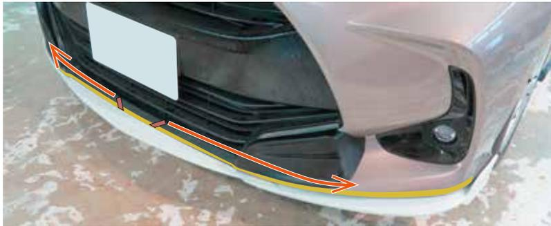
8. ①ディフューザー（センター）の離型紙を50mm程剥がし、マスキングテープ等で①ディフューザーに貼り付ける。
