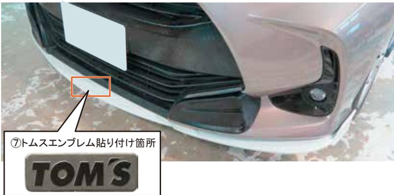
10. ①ディフューザー（センター）の凹み部を脱脂処理し、⑦トムスエンブレムを貼り付け、車両のマスキングテープを剥がす。
