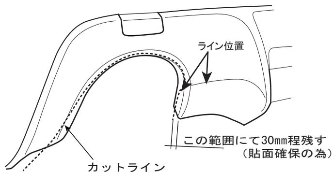
1. バンパーに⑤合わせ治具を使用し、破線ラインにてカットする。
