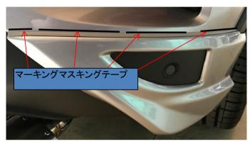
3.仮合わせ位置を決めたら左図参考に取り付け位置をマスキングテープでマーキングをする。フェンダーアーチモール折り返し部分の②タッピングスクリュー穴はマジック等を使用してマーキングをする。
