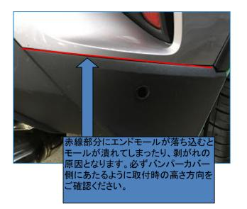
2.仮合わせ時にエンドモールがバンパーカバーと 樹脂パーツの境目に落ち込まない様に必ず エンドモールがバンパーカバー側にあたるように 注意をする。(左図参照)
