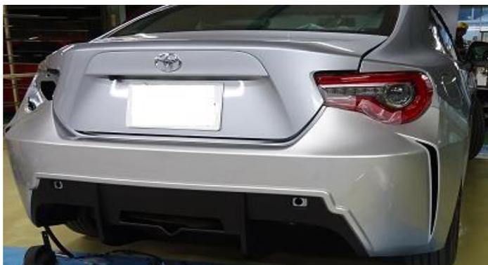
7.①バンパーを純正クリップ、スクリューを使用して取り付ける。
