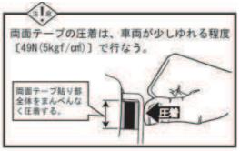
両面テーブの貼り直しをすると、接着力が極端に低下するため、ボディーに付かない様に 気を付けて作業を行う。
