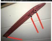
4. 取り外したリフレクター裏面の突起部を左図を参照にカットをする。(赤線指示部分) ①リヤディフューザーに⑦両面テープを使用し 貼り付ける。
