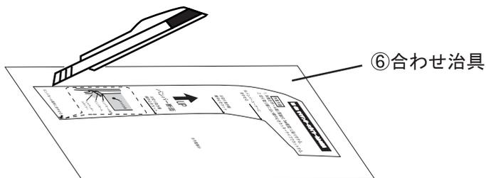
3. ⑥合わせ治具をボール紙(厚紙t0.5mm程度)に貼り付け、切り取り線に沿って線中心をカッターナイフ等でカットする。
