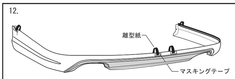
12. ①リヤアンダースポイラーの両面テープ離型紙を50mm程剥がし、①リヤアンダースポイラー表面側に折り返し、マスキングテープで貼り付ける。(左図参照)
