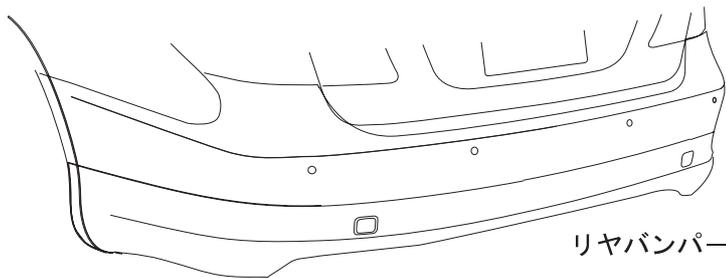
2. 純正リヤバンパーを車両に戻し下面のクリップ以外のビス等は、全て本締めする。
