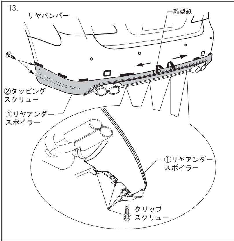
13. ①リアアンダースポイラーをバンパーにあてがい下部に純正クリップスクリュー4ヶ所フェンダーアーチ部には②タッピングスクリュー4ヶ所仮止めをする。
