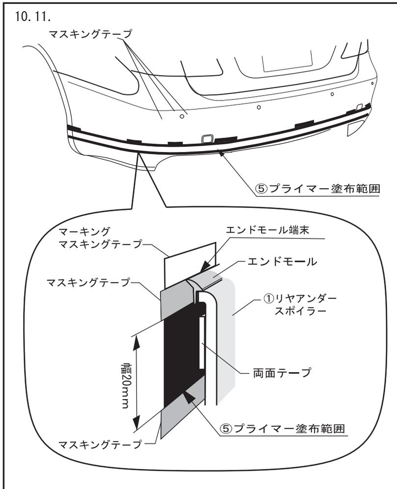
10. ①リヤアンダースポイラーの両面テープ貼り付け位置を確認し⑤プライマー塗布範囲をマスキングテープでマスキングする。(左図参照)
