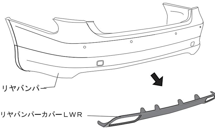
1. 純正バンパーを車両から取り外しリヤバンパーカバーLWRを純正バンパーから取り外す。
