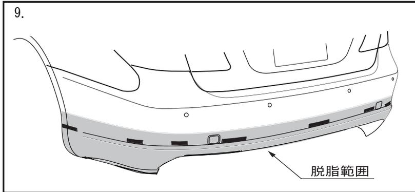
9. リヤバンパーのゴミ、ホコリをウエスで除き脱脂処理を行う。(左図参照)
