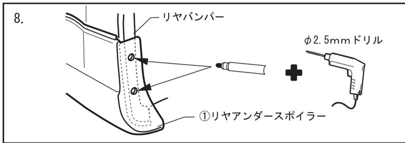
8. 取り付け位置を合わせてマーキングし、スポイラーを一度はずしてφ2.5mmの穴を2ヶ所あける。(左図参照)
