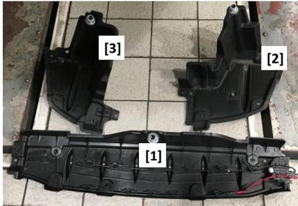
8.車両から取り外した左図[1]リヤボディフロアーカバーRR、[2]フロアーアンダーカバーNo.1、[3]フロアーアンダーカバーNo.2を取り付ける。
