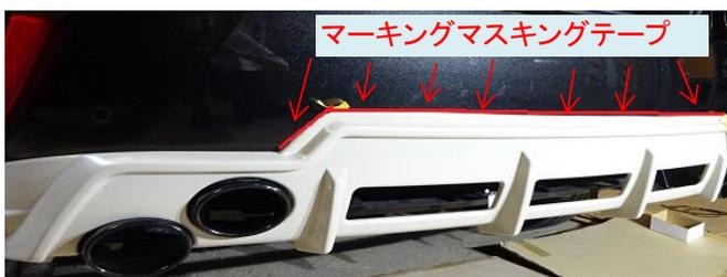
6.①リヤアンダーの両面テープ貼り付け位置を左図を参照に確認する。
