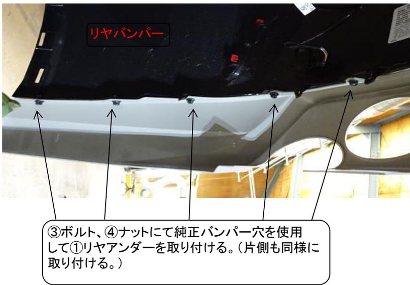
3.リヤバンパーロアガーニッシュを取り外したリヤバンパーに①リヤアンダースポイラーを左図を参考に③ボルト、④ナットを使用して取り付け。
