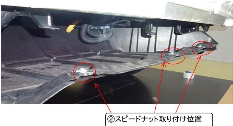
4.②スピードナットを車両側アンダーカバーに取り付ける(ブラケットA取り付け用)
