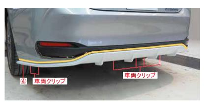
4. 手順 1. で取り外した車両クリップ 8 個と、④アップセットボルトを使用し、①ディフューザーを車両に仮合わせし、両面テープ貼り付け位置をマスキングテープ等でマーキングする。
