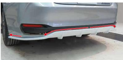
6. ①ディフューザーを車両にあてがい、車両クリップと④ア プセットボルトを仮止めする。
