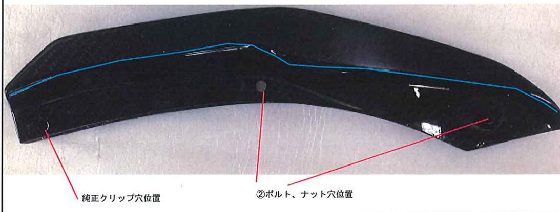
2. ①リヤバンパーフィンをバンパーにあてがい純正クリップスクリューで仮り止めをし、装着位置の確認をする。
