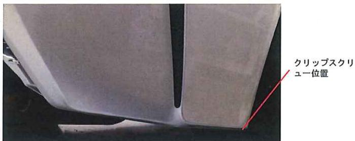
1. バンパー下側の左右クリップスクリューを2個外す。(左図参照)
