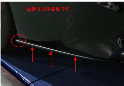
1赤○部分のクリップを取り外し、①フィンを車両に仮あわせをする。(赤○クリップは再使用する)
