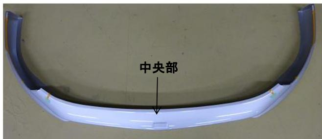
4.①スポイラーの両面テープ離形紙を50mm程剥がしスポイラー表面側に折り返し、マスキングテープで貼り付ける。
