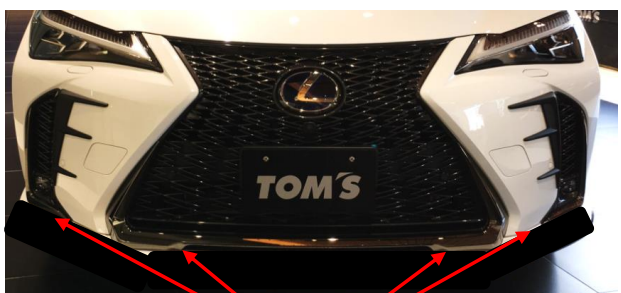
車両エンジンアンダーカバー固定ボルトを4本取り外す。 【図1】
