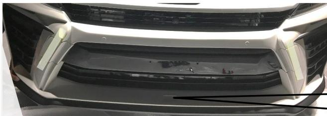
9.①フロントスポイラー中央部のエンブレム貼り付け部の脱脂を行い、⑨TOM'Sエンブレムを貼り付ける。
