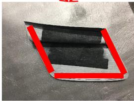
8.①フロントバンパーカバー左右牽引フックカバー部に⑧両面テープを貼り付け、①フロントバンパーへ貼り付ける。
