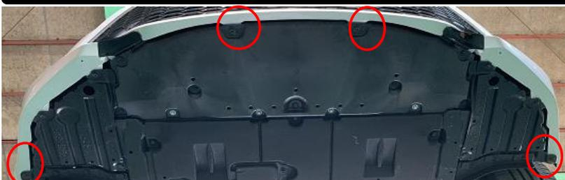
1.フロントバンパー○印の車両ビスを4本(左図参照)を取り外す。
