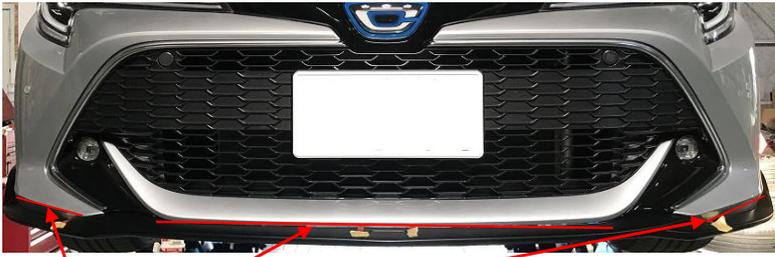
4.①ディフューザーを車両にあてがい取付面を確認する。
