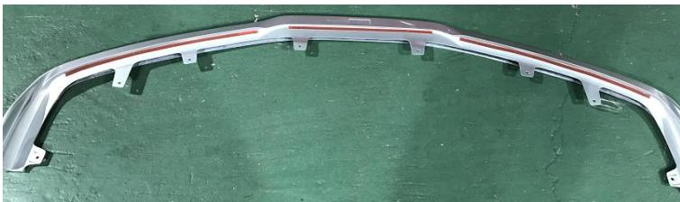
2.①ディフューザーに②両面テープを左図を参照に貼り付けをする。
