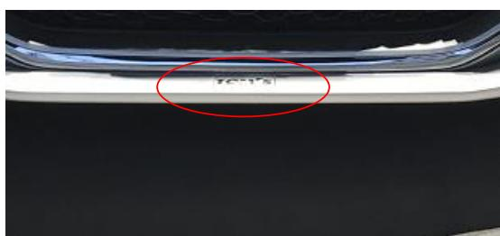
4.①ディフューザーを取り外し両面テープ貼り付け位置を脱脂処理をし、③PACプライマーを塗布する。
