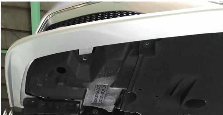
3.①ディフューザーを車両にあてがい取付面を確認する。
