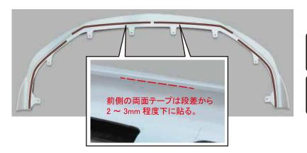
3. ①ディフューザーに②両面テープを貼り付ける。(左図参照)
