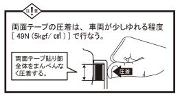
7. ①ディフューザーの凹み部を脱脂処理し、④トムスエンブレムを貼り付ける。
