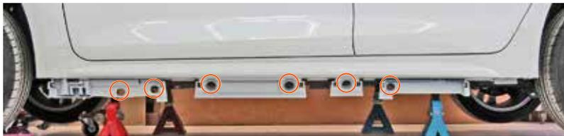
4. 車両のロックパネルモールディングの下面クリップ6箇所を取り外し、ロックパネルモールディング下面を外す。
