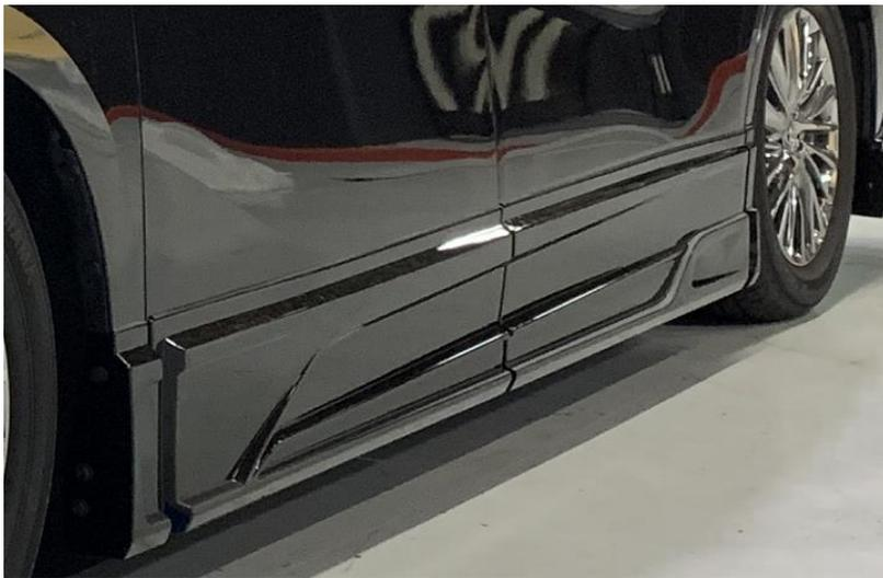
6. ①サイドステップを取り外し、両面テープ接着面を脱脂、⑫プライマー塗布をする。
