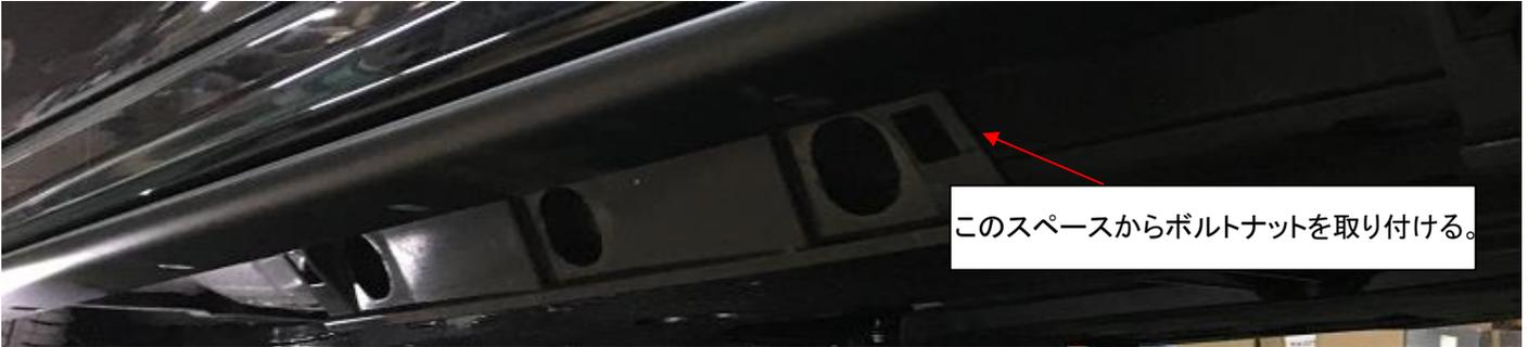
7.②③のボルト、ナットを使用して5.でめくったスペースを使用し①ディフューザーを取り付ける。
