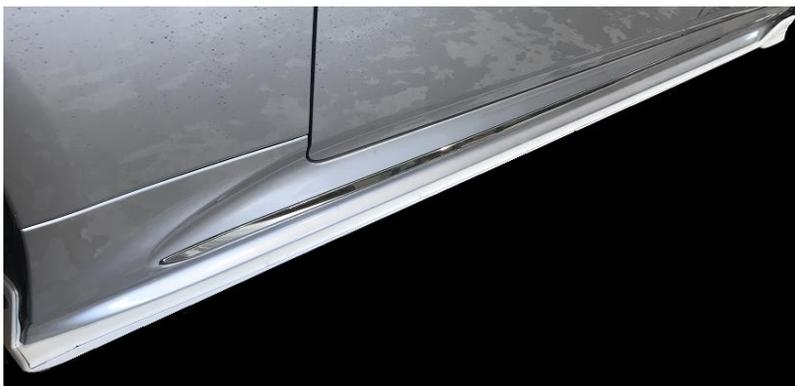
5.①ディフューザーを組付けたロックパネルを純正ビス、下面クリップを再使用して車両に取り付けをする。
