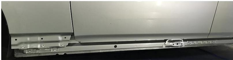
3.車両のロックパネルモールディングの下面クリップ前後ドアを開閉しビスを取り外しロックパネルモールディングを取り外す。
