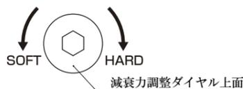
**注意** 締めきり(0段)での使用は破損の原因となりますので、使用しないでください。減衰力は1~40段の範囲で調整出来ます。構造上40段以上に戻りますが、破損の原因となりますので必ず1~40段の範囲で調整してください。
