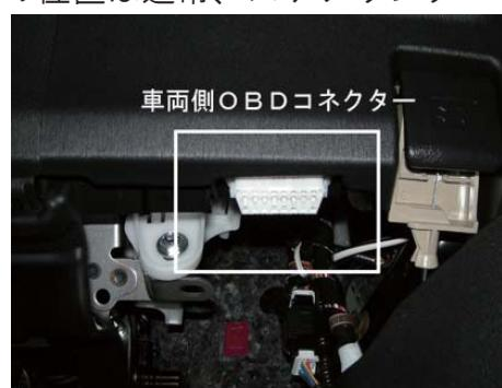
※裏面にある黄色いロックを下げた状態で差込んでからロックを上に上げて確実に固定してください。
