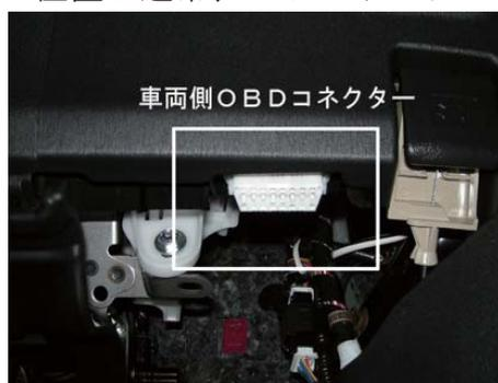
※裏面にある黄色いロックを下げた状態で差込んでからロックを上を上げて確実に固定してください。
