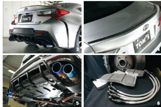
の側面に翼状に立ち上がった部分も、ホイールハウス内の空気を積極的に抜く作用があるという。一方マフラーは排気の流れが直線的になるストレートスルー構造になっており、リヤエンドには青く焼けた4本のチタン製テールパイプが張り出している。抜けのいいマフラーによってエンジン出力は10psほど向上しているという。
